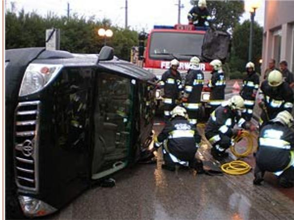
Der 2,5 Tonnen schwere Geländewagen konnte erst mit Hilfe von Hebekissen und einer Seilwinde wieder aufgerichtet werden.
