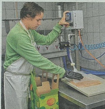
Die Abfüllung erfolgt mit dem so genannten „Bag-in-Box“-System
